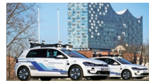
Die autonomen e-Golf haben elf Laserscanner, sieben Radarsensoren und 14 Kameras an Bord
