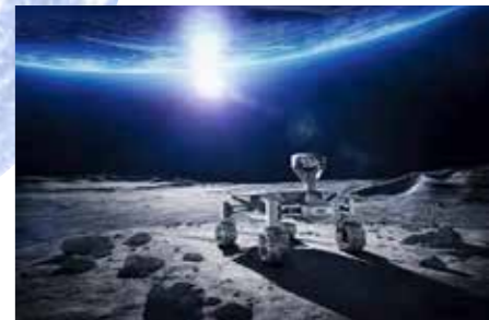
Audi Lunar Quattro. Allradantrieb, e-tron-Motor mit Solaraufladung, volle Mondzulassung.
